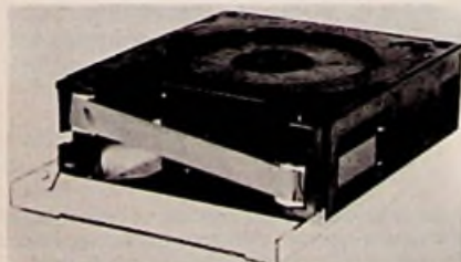
De videoband loopt in de cassette van de onderste bandspoel naar de bovenste bandspoel diagonaal langs één open zijde van de cassette.
