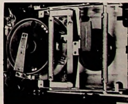
Bovenaanzicht van de cassettelift en de videokoppentrommel. Met behulp van twee pennen wordt de magneetband over 180° rond de trommel getrokken.
